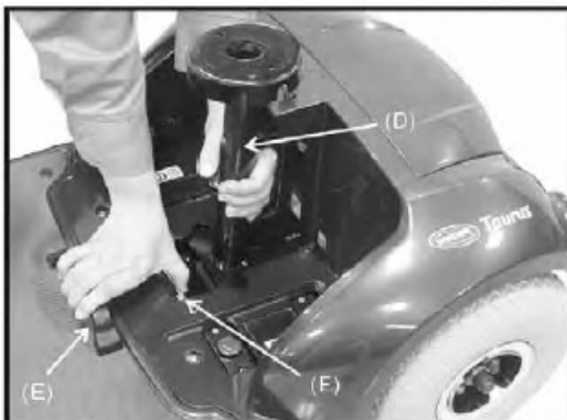
Figura 3. Agarre el tubo (D) y el asa (E) de la plataforma. Apriete el botón de apertura rápida (F) para desbloquear el sistema.
