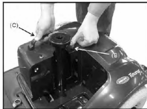
Figura 2. Apriete el botón de desbloqueo del Pack de baterías (B) . Tirar del asa del pack de baterías (C) para sacarlo del scooter. Las baterías pesan. Al levantarlas, por favor, adopte la postura correcta para evitar lesiones. Si hace falta, pide ayuda.
