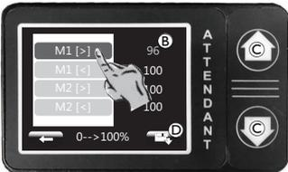
Toque el pistón que desee (> = extender < = retraer) para cambiar el valor (B) pulsando las lechas hacia arriba o hacia abajo (C). Toque el botón (D) para guardar después de cada ajuste.
