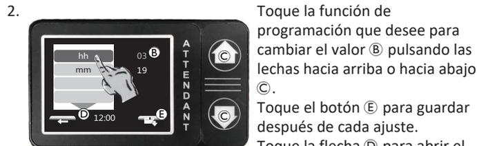
Toque la función de programación que desee para cambiar el valor **B** pulsando las flechas hacia arriba o hacia abajo **C**.
