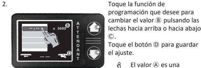
Toque la función de programación que desee para cambiar el valor **B** pulsando las lechas hacia arriba o hacia abajo **C**.
