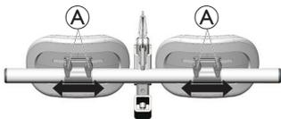
1. Afloje los tornillos de mariposa **A** y deslice los apoya-rodillas hacia adentro o hacia afuera hasta la posición que desee en el larguero.
