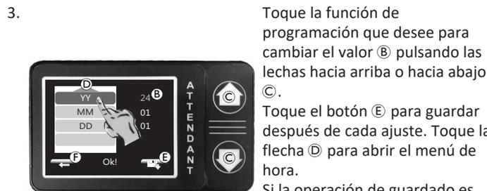
Toque la función de programación que desee para cambiar el valor **B** pulsando las flechas hacia arriba o hacia abajo **C**.
