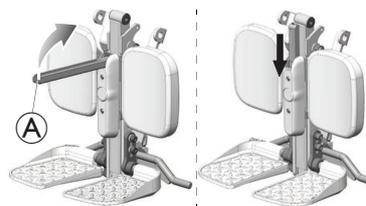
1. Eleve la barra de montaje **A** y guárdala detrás de la cubierta del reposapiernas.
