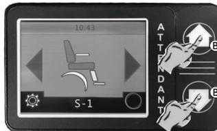
Si se muestra la función de asiento deseada, mantenga pulsadas las flechas hacia arriba o hacia abajo Ⓑ para hacer funcionar la función de posicionamiento eléctrico hasta la posición deseada.
