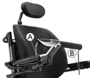
1. Levante la barra pectoral hacia arriba hasta que el poste más corto se suelte de su soporte de montaje **A**.
