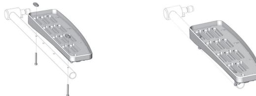
1. Con el hardware suministrado, instale el cuerpo de la almohadilla del reposabrazos moldeado en el tubo del reposabrazos en la orientación de montaje predeterminada (ver arriba) y la posición de la almohadilla del reposabrazos (consulte los ajustes de ancho y profundidad a continuación).
