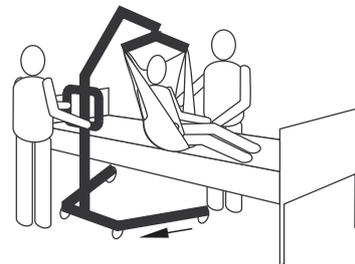
Utilizando las barras de empuje, aleje la grúa de la superficie de descanso.
