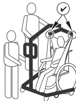
Levante el brazo hasta que haya tensión en las correas de la eslinga y asegúrese de que la eslinga esté correctamente fijada a los ganchos de la percha. Consulte 6.2.1 *Acoplamiento de la eslinga a la grúa, page 20.* Si algún acoplamiento no está bien colocado, vuelva a bajar al paciente hasta sentarlo en la silla de ruedas y corrija el problema.
