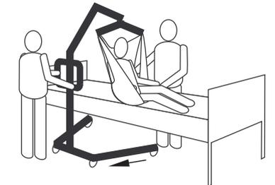
Utilizando las barras de empuje, aleje la grúa de la superficie de descanso.
