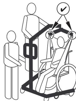
Levante el brazo hasta que haya tensión en las correas de la eslinga y asegúrese de que la eslinga esté correctamente fijada a los ganchos de la percha. Consulte 6.2.1 *Acoplamiento de la eslinga a la grúa, página 21*. Si algún acoplamiento no está bien colocado, vuelva a bajar al paciente hasta sentarlo en la silla de ruedas y corrija el problema.
