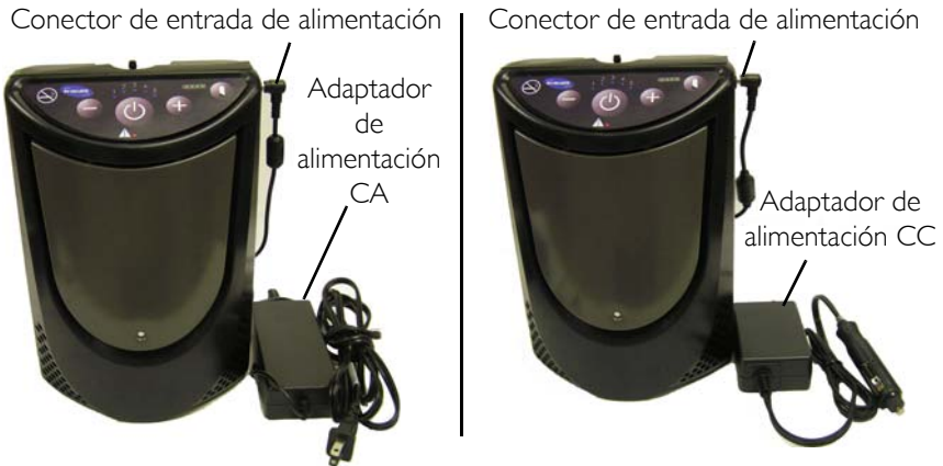
FIGURA 6.3 Carga de la batería interna
