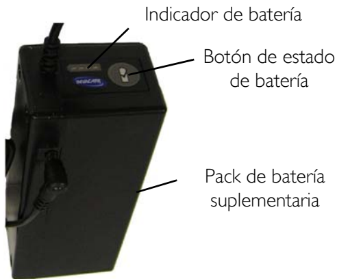
FIGURA 6.4 Cargar únicamente la batería suplementaria
