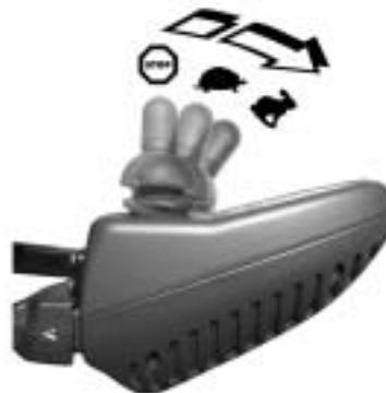
**Cuanto más se mueve el joystick en una determinada dirección, más dinámicamente reacciona la silla de ruedas.**
